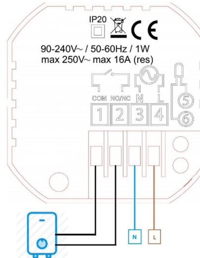
Zapojení s bezpotenciálovým kontaktem (Dry Contact – suchý kontakt) pro ovládání kotlů – elektrických, plynových, na pevná paliva a tepelných čerpadel. Na kontaktech 1 a 2 (NO a COM) není žádné napětí, pouze dojde k sepnutí těchto kontaktů. Pro zařízení je to signálem, že má topit.
