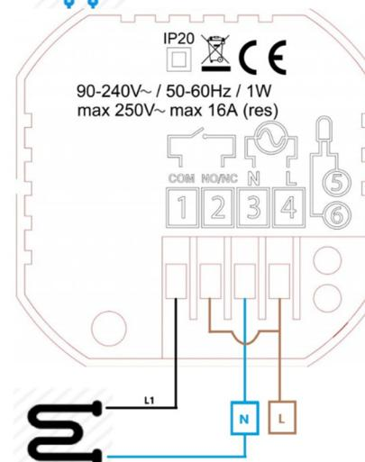
Zapojení pro napěťové spínání – pro elektrické vytápění, vodní podlahové topení, elektrické topení, elektrické konvektory, infrazářiče apod.
